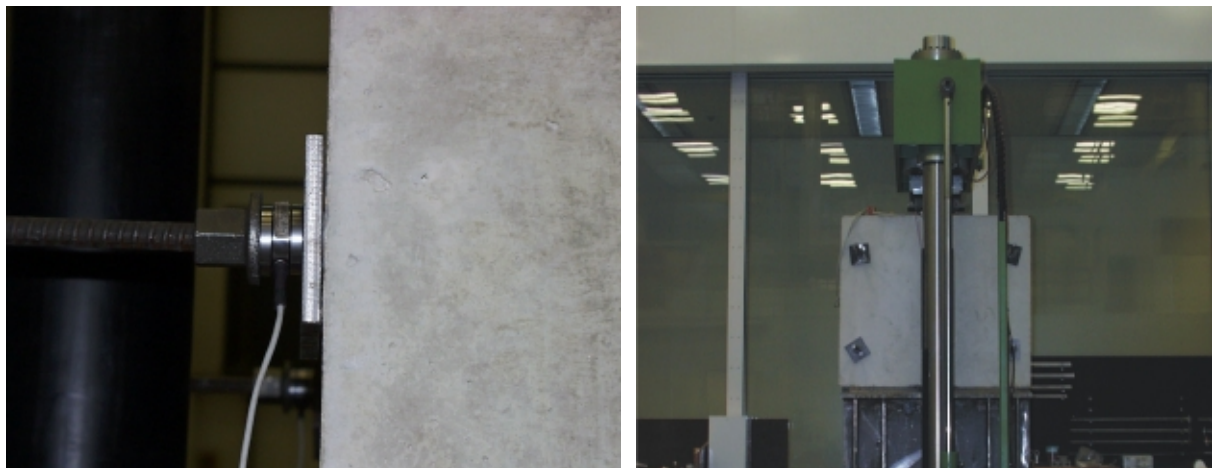
Bild 14 Zugstangen zur Simulation der ständigen Lasten Fig. 14 Tension bars to simulate permanent loads
